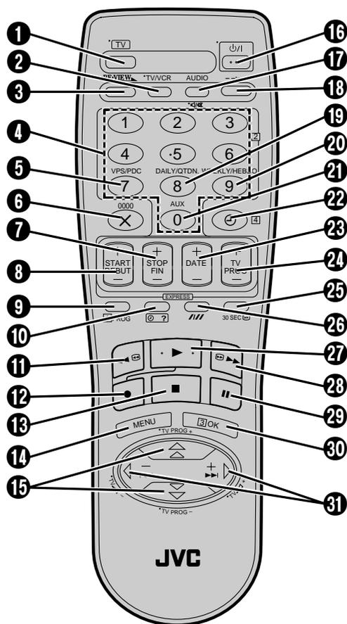
Les touches avec un petit point sur la gauche du nom peuvent également être utilisées pour commander un téléviseur JVC tout en maintenant pressé la touche TV. (☞ "Fonctionnement de téléviseurs JVC" à la page 57.)
